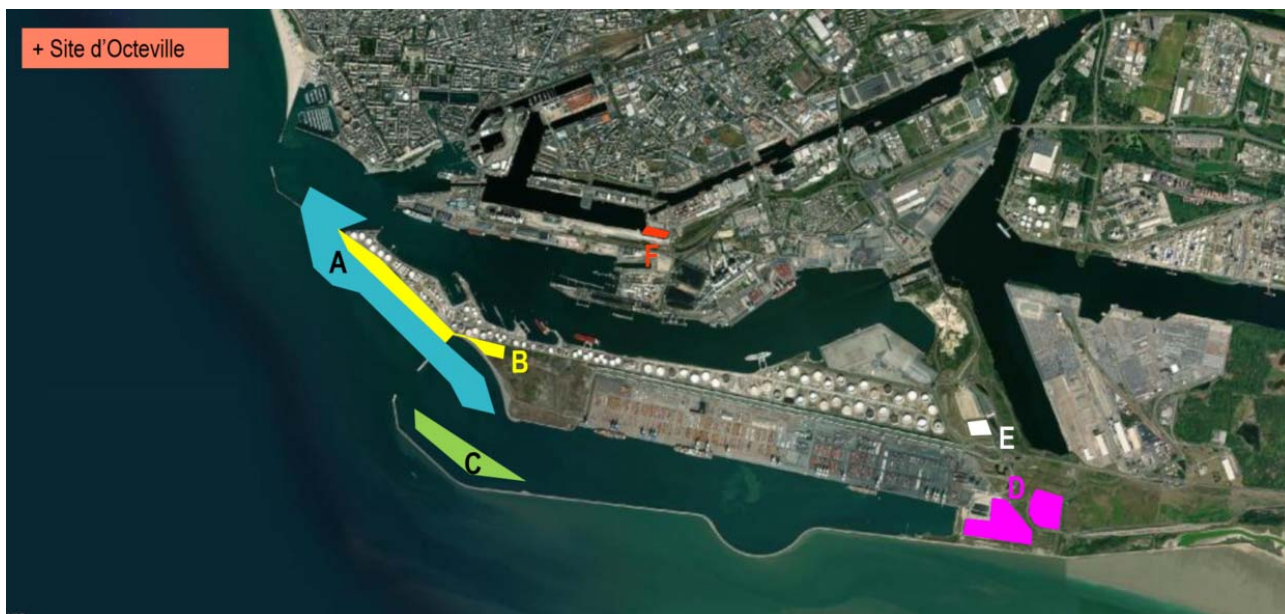
Figure 49 : Emprises portuaires nécessaires pendant la phase travaux
