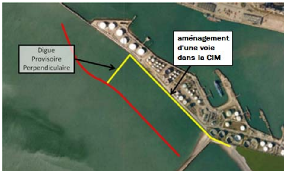
Figure 62 : Ouvrages provisoires en phase travaux
