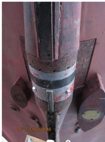
Figure 255 : Illustration de la base d'un sondeur multifaisceaux (de type Reson 7101) sur la coque de la vedette hydrographique « Hyphos »
