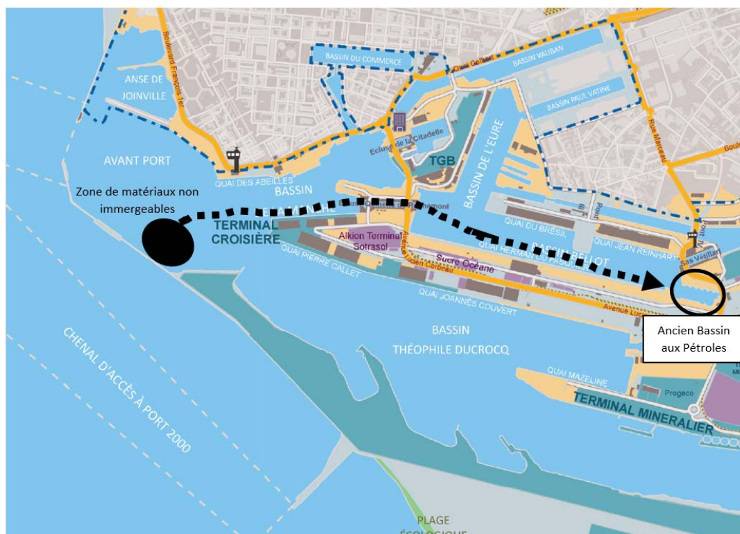
Figure 56 : Trajet emprunté par les dragues pour acheminer les matériaux non immergeables dans l'Ancien Bassin aux Pétroles
