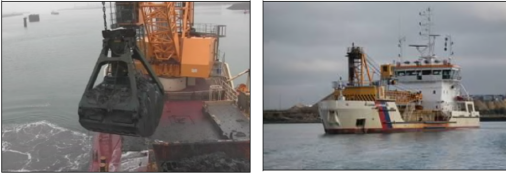
Dragage par moyens nautiques : drague mixte Gambe d'Amfard
