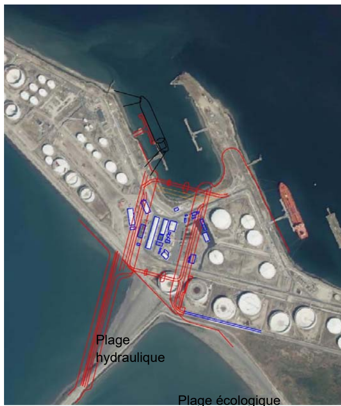
Figure 25 : Option de traversée de la CIM – côté ouest de la digue nord de Port 2000
