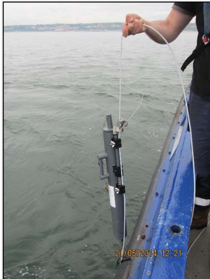
Figure 129 : Bouteille de prélèvement d'eau « Niskin »
