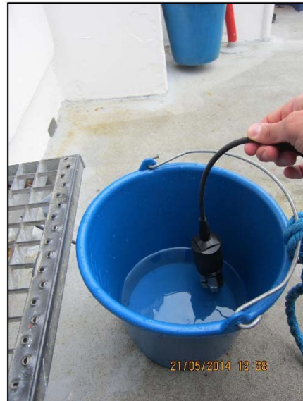
Figure 130 : Mesure des paramètres in-situ à l'aide d'une sonde multiparamètres
